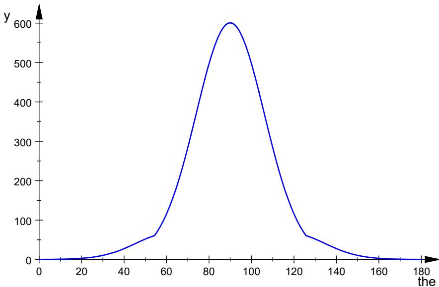
Maximalwert der relativen Stahlungsleistungsichte , auch in dBi
