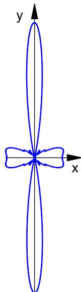
horizontale relative Strahlungsleistungsdichte
