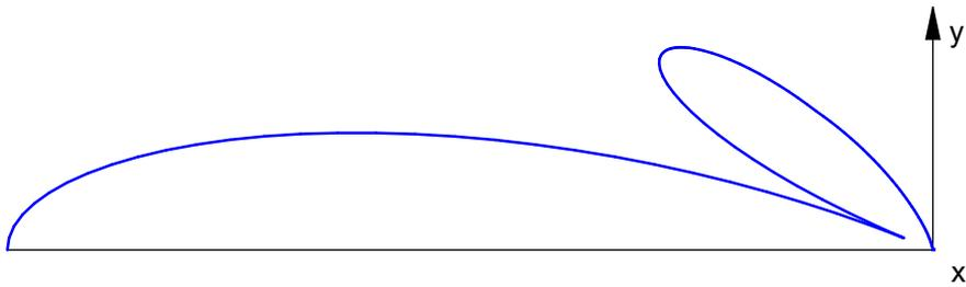
vertikale relative Strahlungsleistungsdichte
