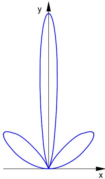
horizontale relative Strahlungsleistungsdichte
