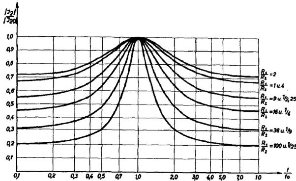
Bild 4 a. Betrag des auf  $I_{20}$  bezogenen Sekundärstromes der Boucherot-Brücke als Funktion der relativen Frequenz bei verschiedenen Verhältnissen  $R_1/R_2$
