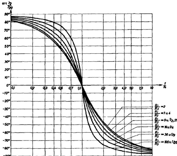
Bild 4 b. Phase des auf  $I_{20}$  bezogenen Sekundärstromes der Boucherot-Brücke als Funktion der relativen Frequenz bei verschiedenen Verhältnissen  $R_1/R_2$
