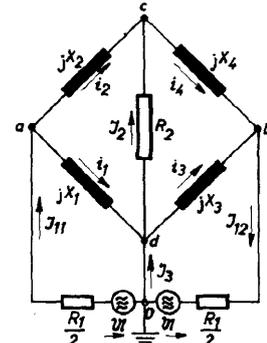
Bild 2. Anpassung eines erdsymmetrischen Generators an einen erdunsymmetrischen Widerstand mittels Boucherot-Brücke
