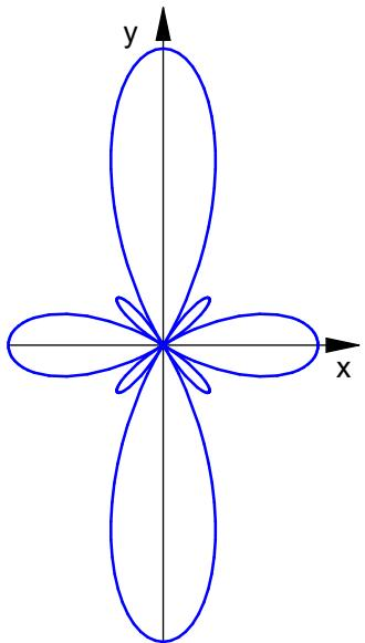
horizontale relative Strahlungsleistungsdichte
