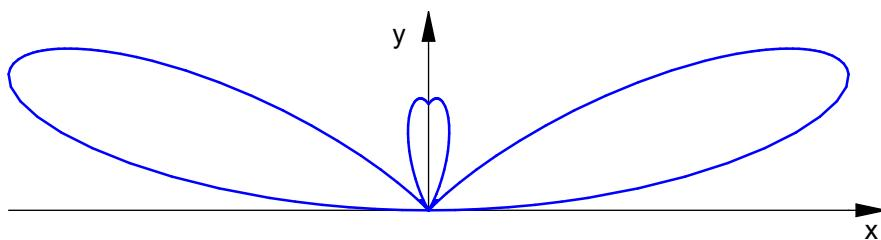
vertikale relative Strahlungsleistungsdichte
