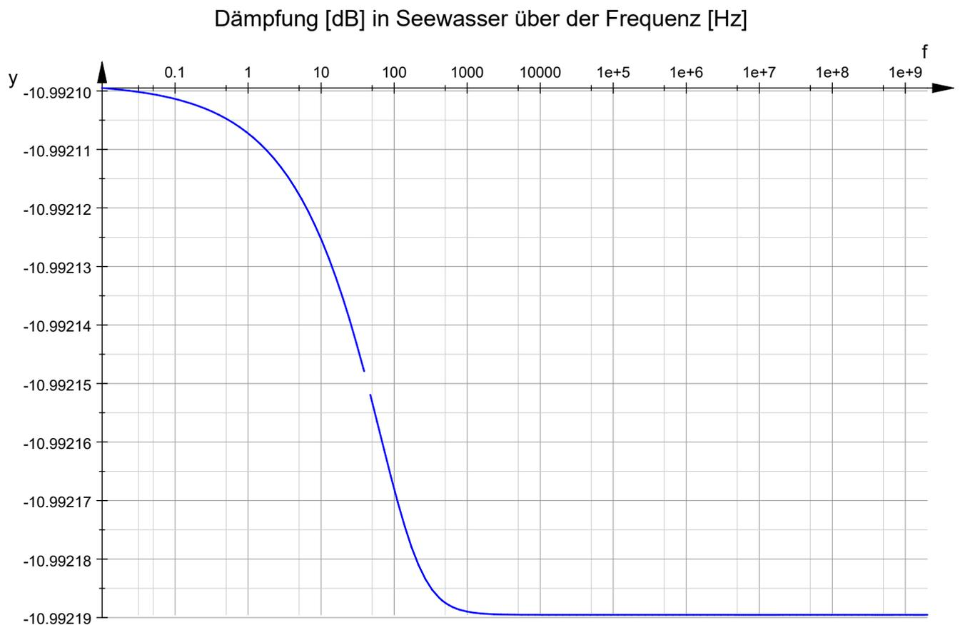
Bild 2 Betrag von Gleichung 1 in dB als Funktion der Frequenz f
