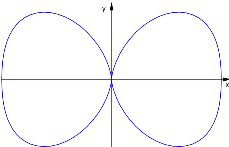
horizontale relative Strahlungsleistungsdichte
