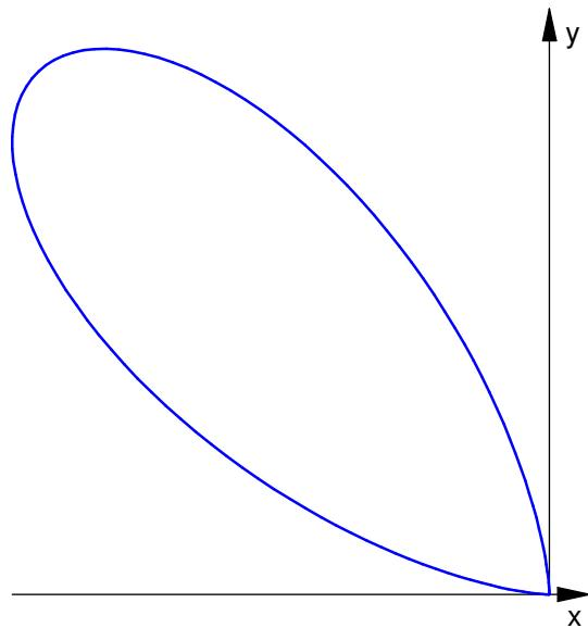
vertikale relative Strahlungsleistungsdichte
