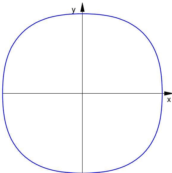
horizontale relative Strahlungsleistungsdichte
