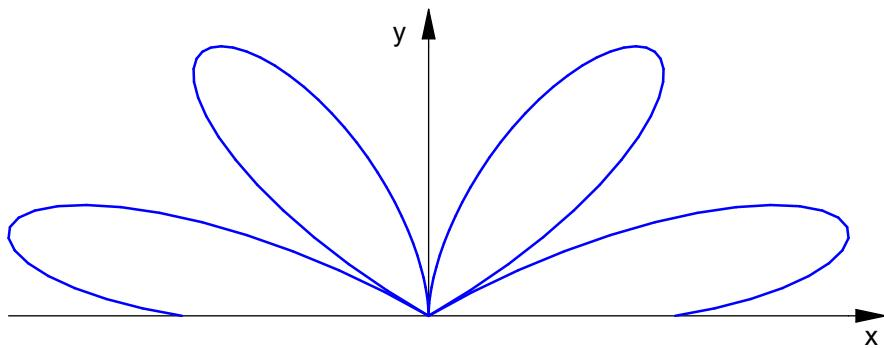
vertikale relative Strahlungsleistungsdichte
