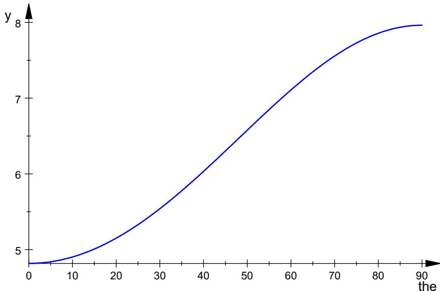
Maximalwert der relativen Stahlungsleistungsichte , auch in dBi, Erhebungswinkel 0 Grad
