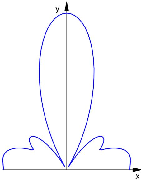
horizontale relative Strahlungsleistungsdichte
