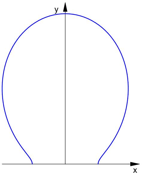
horizontale relative Strahlungsleistungsdichte
